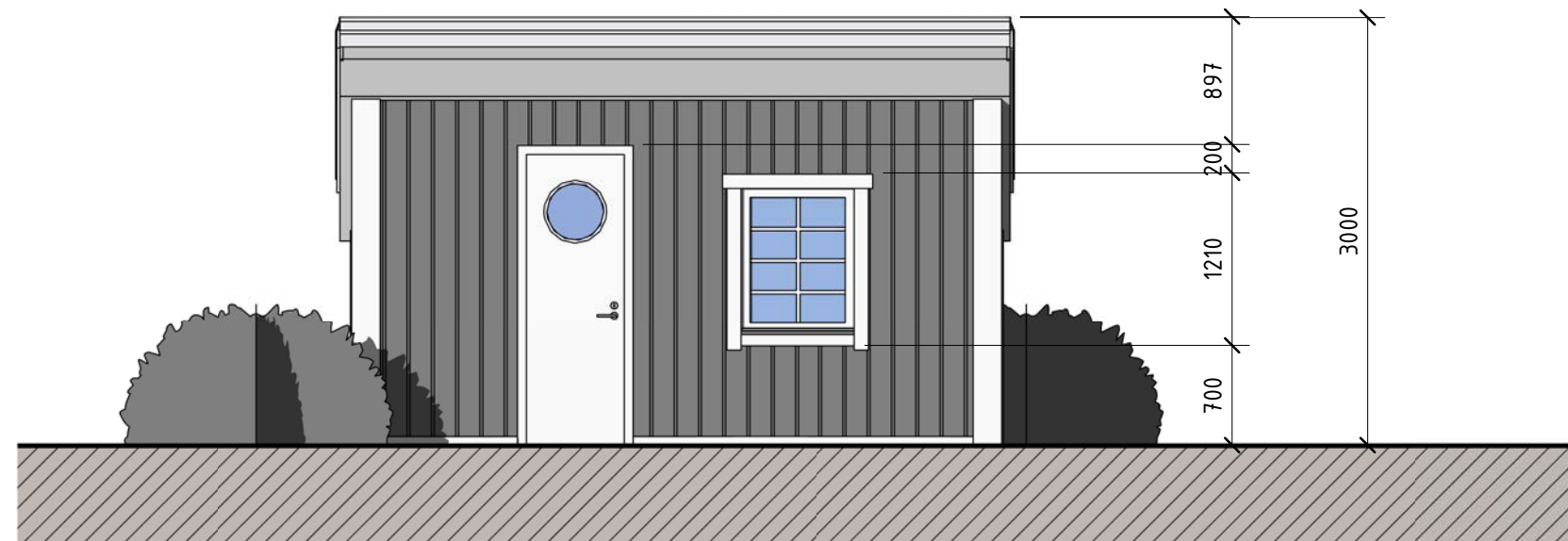
Fasad mot Söder SKALA 1 : 50
